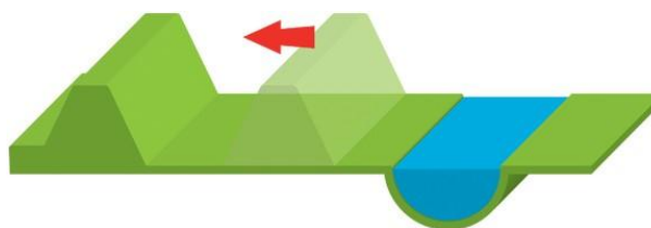
Relocating a dike land inwards, for instance at Cortenoever (Zutphen, the Netherlands). Source: Ruimtevoorderivier.nl
